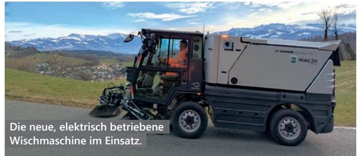
Die neue, elektrisch betriebene Wischmaschine im Einsatz.
