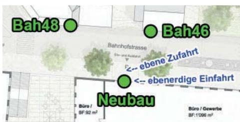
Die Tiefgaragenzufahrt besteht lärmtechnisch aus einer 5 m langen «ebenen Zufahrt» (ab Fahrbahnrand bis Fassade) und einer «ebenerdigen Einfahrt». Die beiden Anlageteile werden separat berechnet und anschliessend energetisch addiert.
