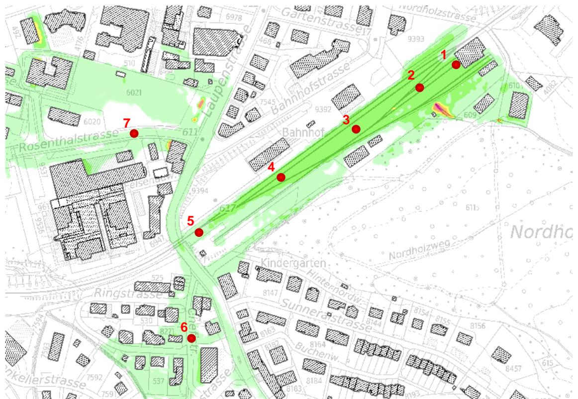
**Abbildung 9: Ausschnitt aus der Wassertiefenkarte HQ300 der Neumodellierung inkl. Abschirmung (vgl. Abbildung 13)**
