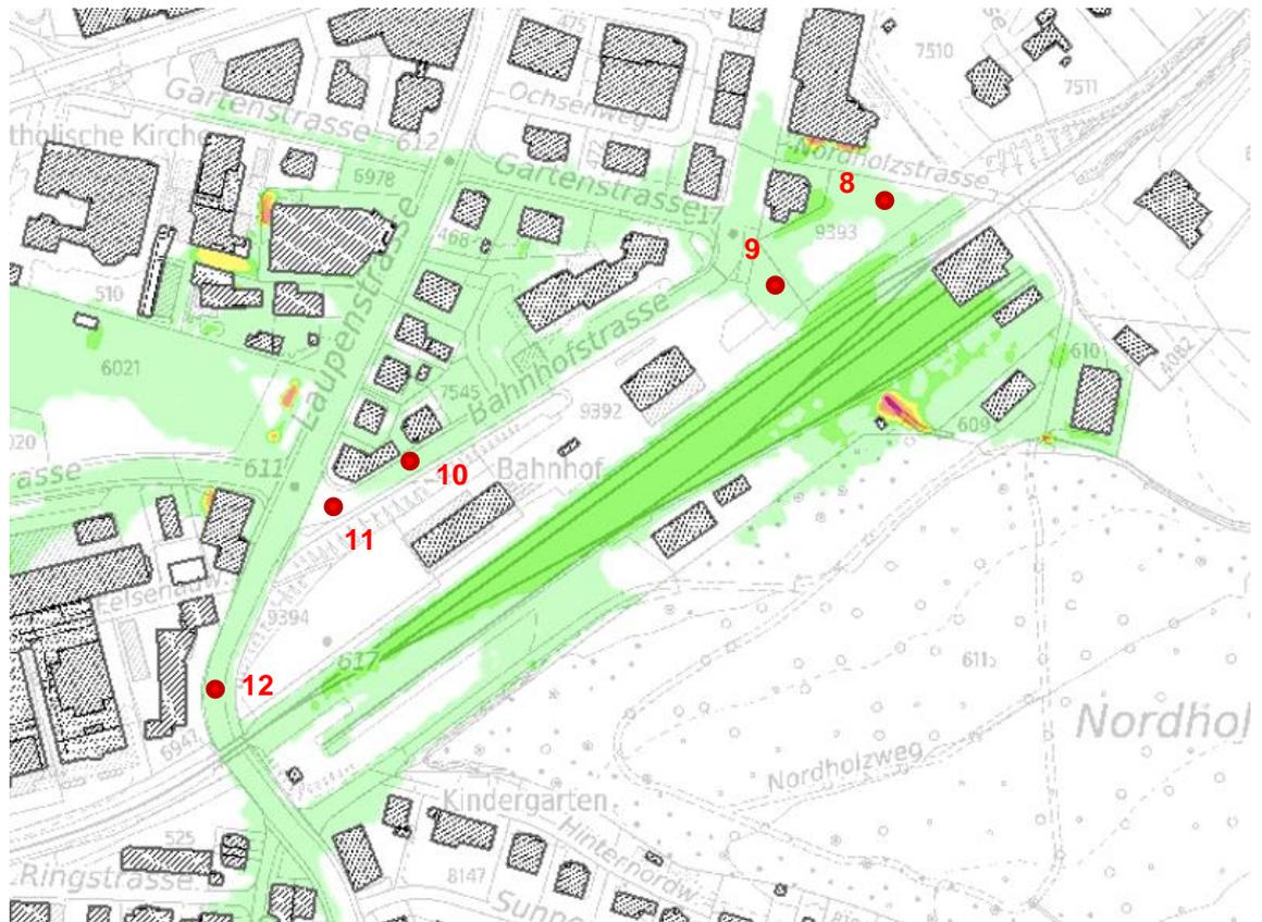
**Abbildung 11: Ausschnitt aus der Wassertiefenkarte HQ300 der Neumodellierung (vgl. Abbildung 12)**
