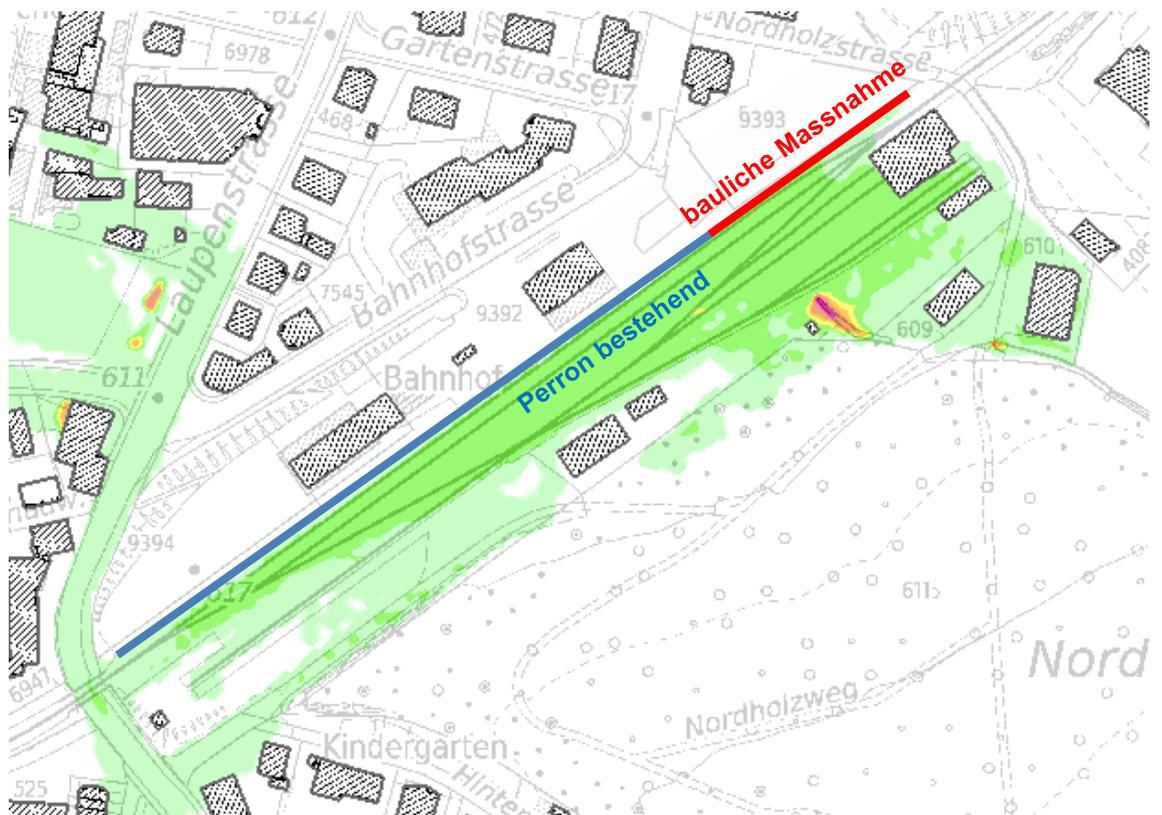
**Abbildung 5: Ausschnitt aus der Wassertiefenkarte HQ300 der Neumodellierung inkl. Abschirmung (vgl. Abbildung 13); Variante Sockelmauer gemäss GP [6]**
