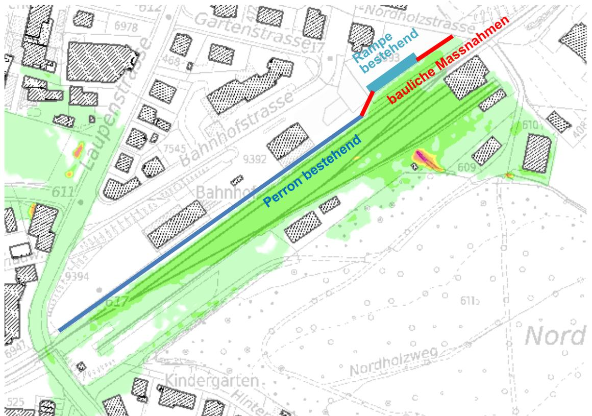
**Abbildung 7: Ausschnitt aus der Wassertiefenkarte HQ300 der Neumodellierung inkl. Abschirmung (vgl. Abbildung 13); Variante Sofortmassnahme**
