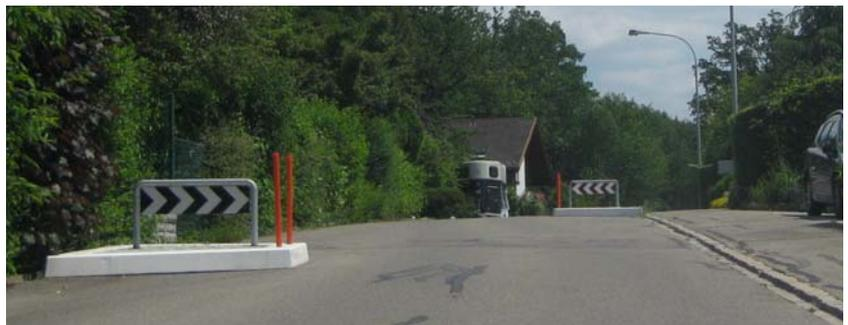
An der Stampfstrasse werden Berliner Kissen vorgesehen. Aufgrund der bestehenden Parkplätze kann abgeschätzt werden, dass durch wechselseitige Einengungen nicht genügend Wirkung erzielt werden kann, um das Geschwindigkeitsniveau auf den Zielwert der Tempo-30-Zone zu senken, so dass hier wirksamere Massnahmen vorzusehen sind.
