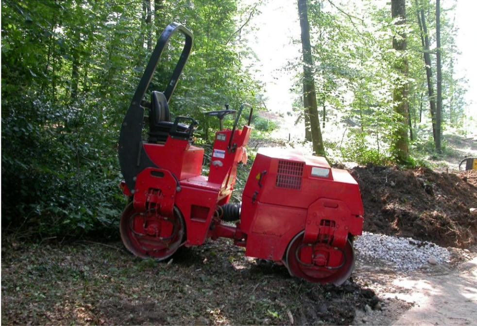
Foto: Tandem-Vibrationswalze; Bomag BW 100 AD-3
