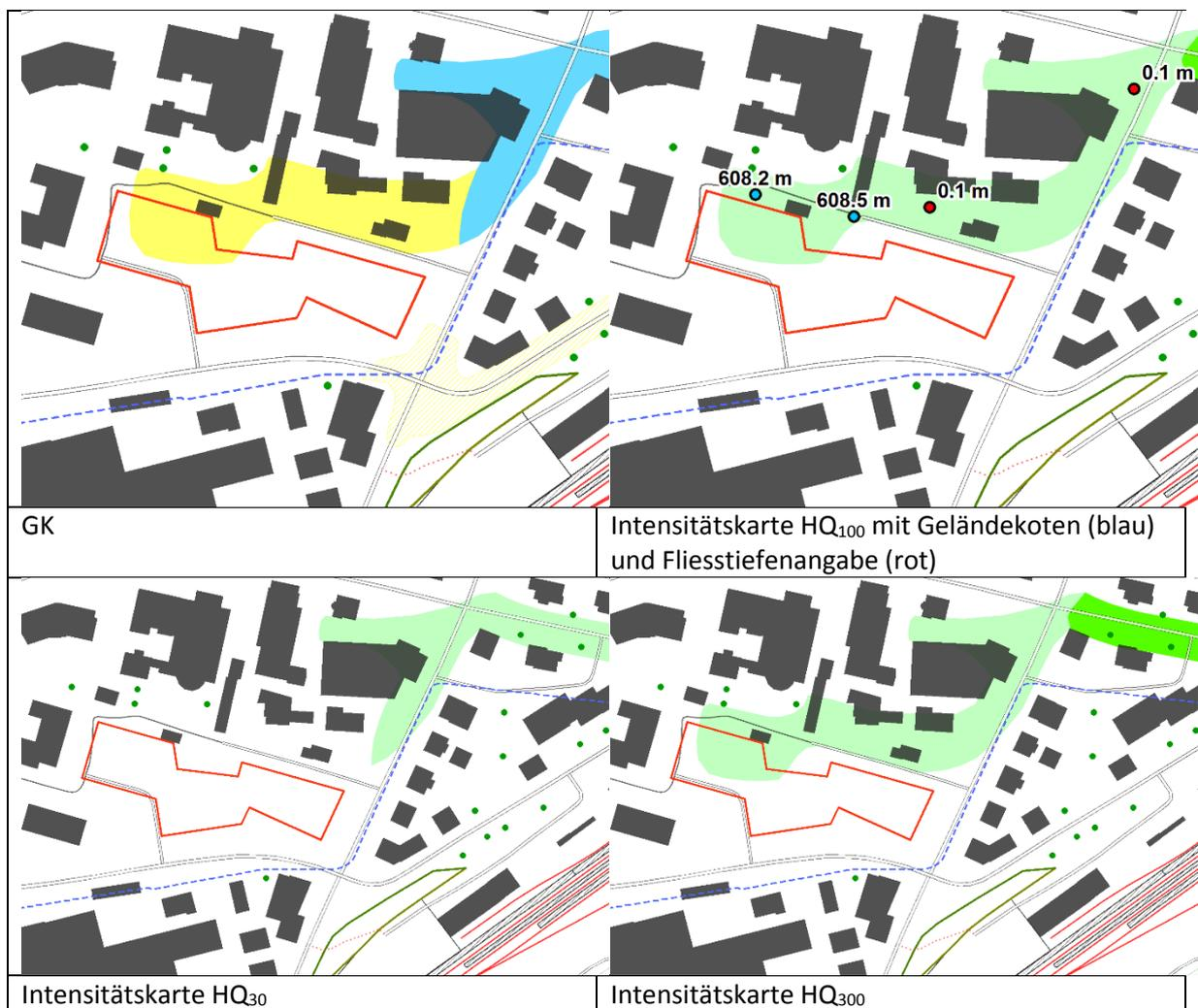
Abbildung 5: Detailansicht zur Gefährdung Hochwasser im Projektperimeter. Bei IK<sub>100</sub> mit Angabe der Wassertiefe und Kote
